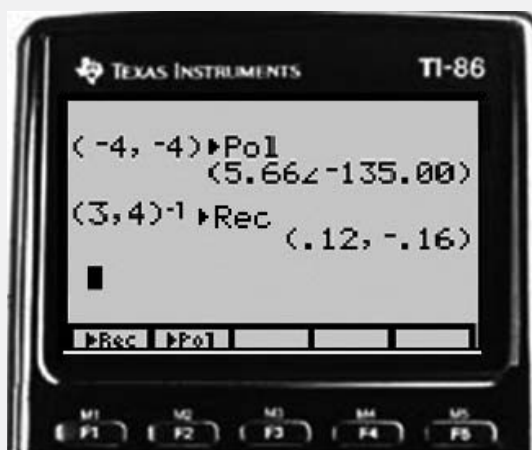
FIGURA 16-6 Despliegue de números complejos en la TI-86. Observe que los resultados polares se muestran en la notación estándar, pero los rectangulares no.
