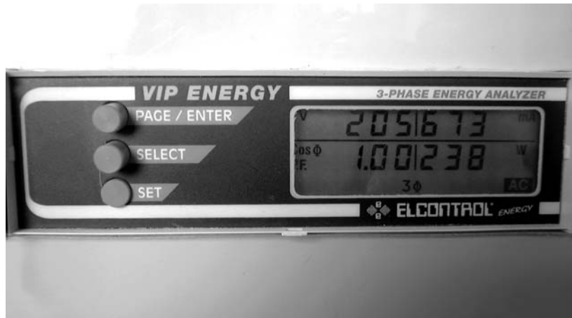
FIGURA 17-23 Medidor multifunción de potencia-energía. Mide potencia activa (W), potencia reactiva (VAR), potencia aparente (VA), factor de potencia energía y otros parámetros.
