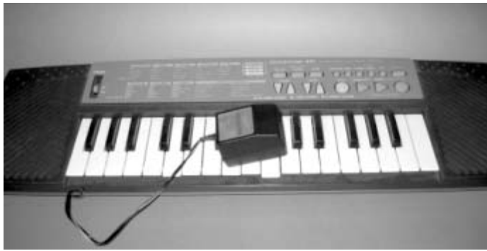
FIGURA 2-21 Los adaptadores de ca se usan como fuente de cd en muchos dispositivos electrónicos.
